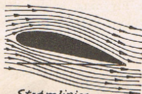
Strømlinier omkring et Plan Fig. 28.
